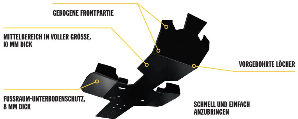
Unser Unterbodenschutz aus Kunststoff gleitet ruckfrei und leise über Hindernisse und sorgt für großartigen Schutz in rauem Gelände. Aus verschleißbeständigem, thermogeformtem hochmolekularem Polyethylen (PE-HMW).
