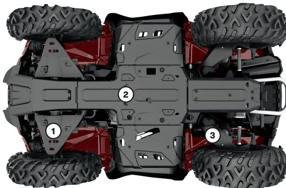
Unser Kunststoff-Unterbodenschutz gleitet ruckfrei und leise über Hindernisse und bietet dabei großartigen Schutz in rauem Gelände. Gefertigt aus 6 mm dickem, abriebbeständigem, thermogeformtem hochmolekularem Polyethylen (PE-HMW).
